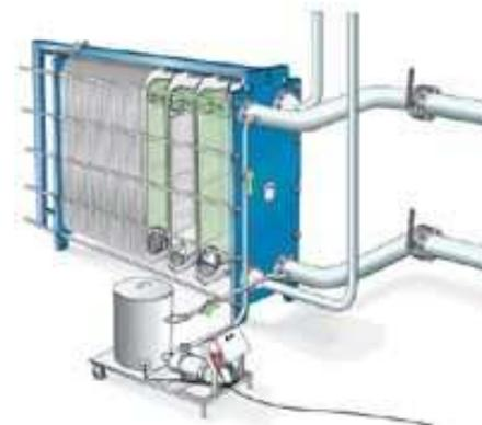
**NEP = système de nettoyage automatique sans démonter l'appareil**
